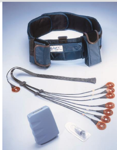
Anteny odbiorcze i rejestrator Źródło: GivenImaging®
