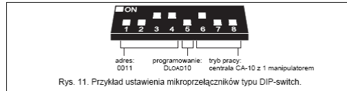
Rys. 11. Przykład ustawienia mikroprzełączników typu DIP-switch.
